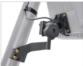
Mit der neuen Nachrüstlösung Terminalhalter können bestehende E- und V-Stapler-Flotten analog zur Serienoption ausgestattet werden. Die stabile höhenverstellbare Halterung wird an der rechten A-Säule des Fahrerschutzdachs befestigt. Neben den mechanischen Komponenten beinhaltet das Kit ein dreidrähtiges Kabel für die Stromversorgung.
