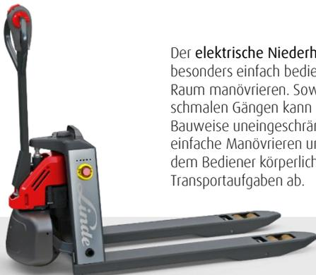
Der elektrische Niederhubwagen MT15C lässt sich besonders einfach bedienen und selbst auf engstem Raum manövrieren. Sowohl im LKW als auch in schmalen Gängen kann er dank seiner kompakten Bauweise uneingeschränkt verwendet werden. Das einfache Manövrieren und der Elektroantrieb nehmen dem Bediener körperlich anstrengende Transportaufgaben ab.
