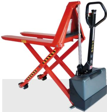
Der **elektrische Scherenhubwagen EHL 1004** kann mit Fernbedienung sowie Positionskontrolle ausgestattet werden. Damit wird eine **konstante automatische Arbeitshöhe** erreicht, so dass dem Anwender eine **ergonomisch korrekte Arbeitsstellung** garantiert wird. Die Gabel hebt sich automatisch beim Entladen und senkt sich beim Beladen.
